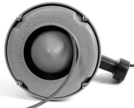
Obrázek 7A - Při ukládání spirály do vnitřního bubnu navíjete spirálu ve směru chodu hodinových ručiček.
